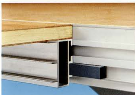
Kunststoffleisten verhindern bei extremer Belastung (z. B. Tanz) Abstufungen in der Bühne
